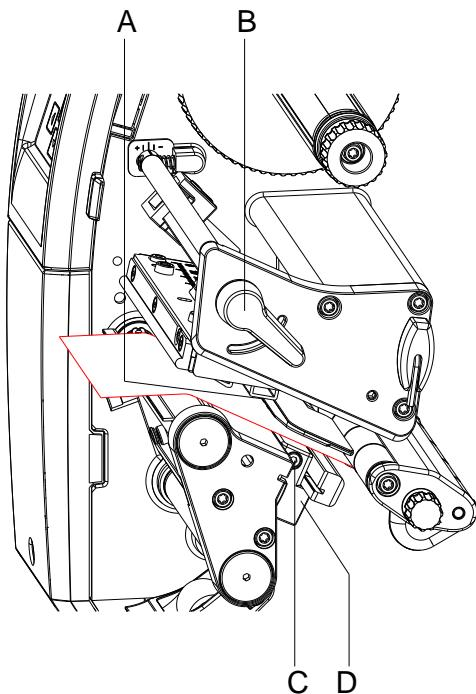
За настройване към материала за етикетите, светлинната бариера за етикетите може да бъде преместена напречно на посоката на движение на хартията. Сензорът (A) на светлинната бариера за етикетите се вижда отпред при поглеждане през печатащия модул и е маркиран с резка в държача на светлинната бариера.
