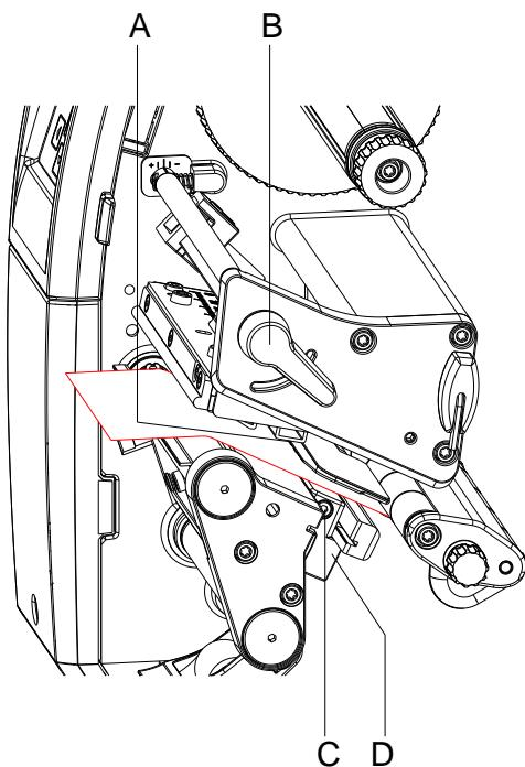
Etiketfotocellen kan forskydes på tværs af papirets løberetning for tilpasning til etiketmaterialet. Fotocellens sensor (A) er synlig forfra gennem printenheden og markeret med en kærv i fotocelleholderen.
