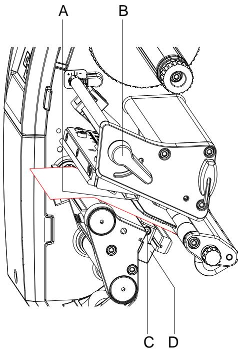
Fotocellsbrytaren kan skjutas på tvären mot pappersrikningen för att anpassas till etikettmaterialet. Sensorn (A) på photocellsbrytaren syns framifrån när man tittar genom utskriftenheten och är markerad med en skåra i photocellsbrytaren.
