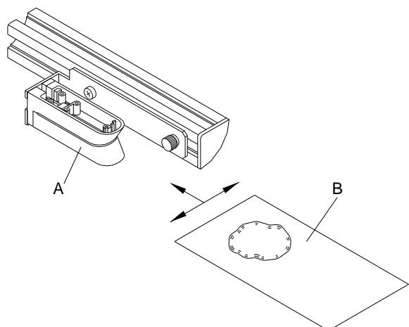
Die Etiketten-Lichtschranke kann durch Papierstaub verschmutzen. Dadurch kann die Etikettenabtastung beeinträchtigt werden.
